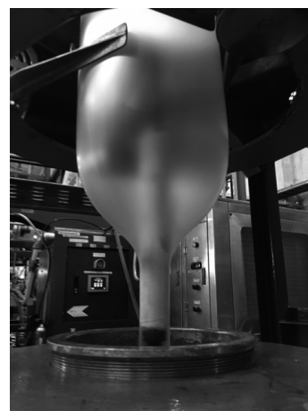
図13 HDPEインフレーションフィルム成形機
