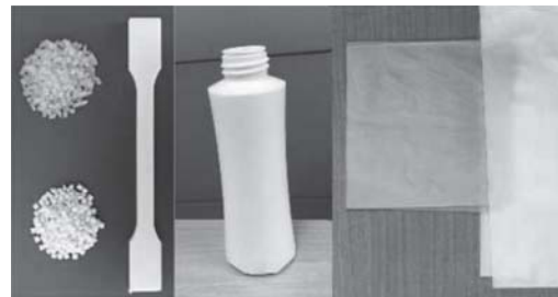
図6 でん粉ペレット、MBBPコンパウンド、ダンベル片（左）、ボトル（中）、フィルム（右）
