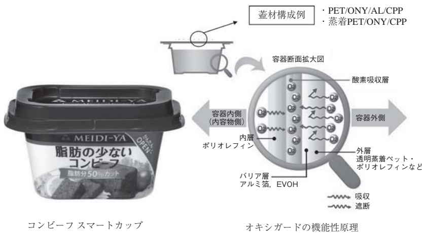
図40 スマートカップとオキシガードの原理
