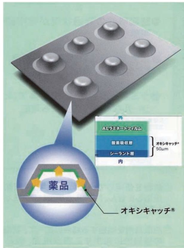
図 19 AL ラミネート 酸素吸収 PTP 包装
