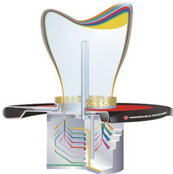
図4 9層構成のインフレーション成形
