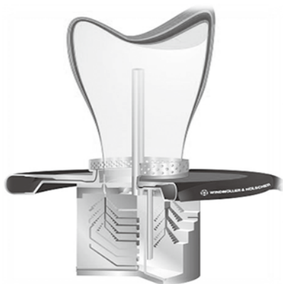
図13 9層構成のインフレーション成形 36) (Windmoller and Hoscher)
