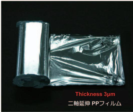
図3 フィルムコンデンサー (HYBRID CAR and EV CAR)
