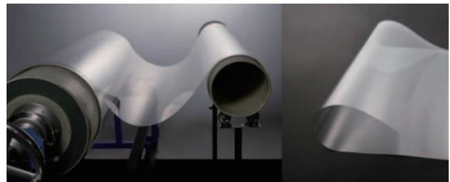
図12 フロート法による厚さ50 $\mu\text{m}$ 、幅1,150mm、長さ100mの極薄ガラス<sup>39)</sup>
